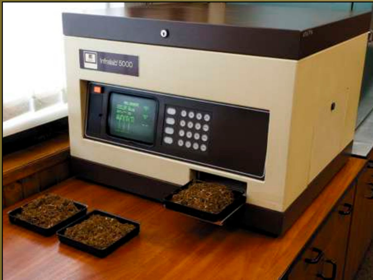
Прилади визначення фізичних властивостей тютюну (фракційного складу та вологості) Devices for determining physical properties of tobacco (fractional structure and humidity)
