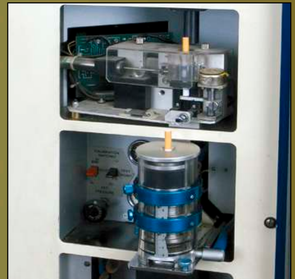
Прилади визначення фізичних властивостей сигарет (вологості, твердості, об'єму) Devices for determining physical properties of cigarettes (humidity, solidity, volume)
